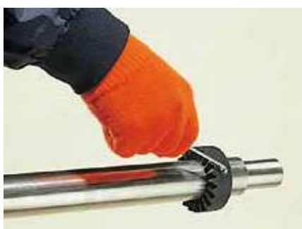
①シャフトの一方にジグザグカラーをはめ、軽くネジをとめます。(※1)
