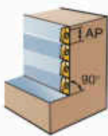
直角肩削り加工 90°の正確な直角肩削り、 最小のミスマッチ量。
