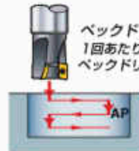
ブランジ加工 大きな工具の突出しと 剛性の低い作業においては、 ブランジカットが唯一可能な加工 方法となることがあります。
