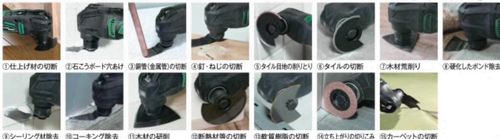
①仕上げ材の切断 ②石こうボード穴あけ ③銅管(金属管)の切断 ④釘・ねじの切断 ⑤タイル目地の削りとり ⑥タイルの切断 ⑦木材荒削り ⑧硬化したボンド除去 ⑨シーリング材除去 ⑩コーキング除去 ⑪木材の研削 ⑫断熱材等の切断 ⑬軟質樹脂の切断 ⑭立ち上がりの切りこみ ⑮カーペットの切断
