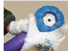
グラインダーのストッパーを押しな がらディスクを右へ最後まで回す。
