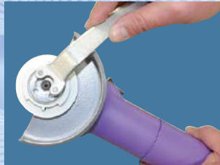
センターキャップをグラインダーに しっかり取り付ける]
