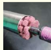
研磨したい箇所の形状にピッタリフィット
