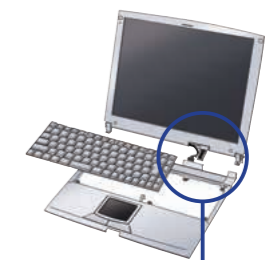
ノートPC機器配線の結束・電気絶縁
