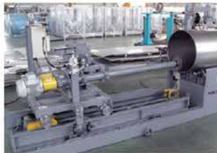
ドラム缶研磨機 ブラシを使用した完全自動研磨機
