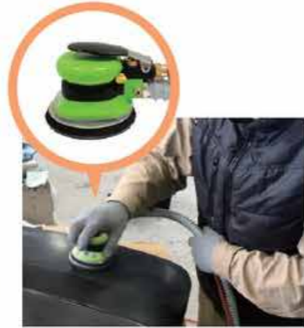
100φのダブルアクションサンダー 軽量化・小型になりフィット感が抜群。
