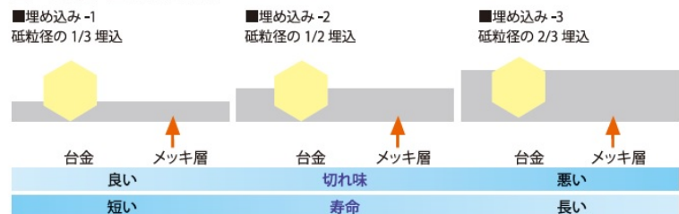
図：砥材の埋め込み規格
