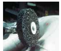
溶接箇所のクリーニング
