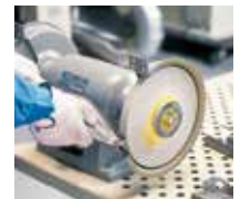
プレス部分のバリ取り
