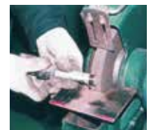
ボルトのクリーニング
