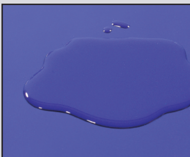
研磨前の塗装面 (ワックスにより水をはじかれている状態)
