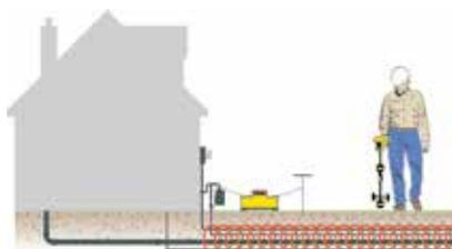
電気・水道等設備配管に直接接続。
