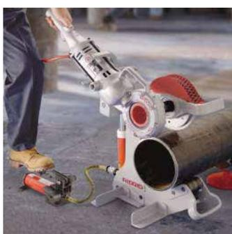
モデル 258 パイプカッタとモデル 700 パワードライブを使って管を切断します。
