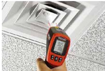
フローシステムで放熱効率を測定し、熱損失の有無や位置を特定します。
