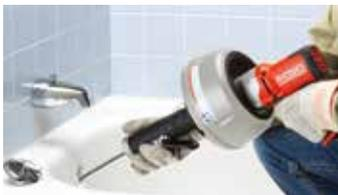
浴槽配管の詰まりをすばやく取り除きます。モーターの逆転なしで、ケーブルの送り戻しが可能。
