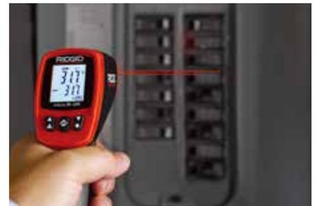
ヒューズや回路遮断器が過熱していないか調べます。過熱していれば回路の過負荷が疑われます。
