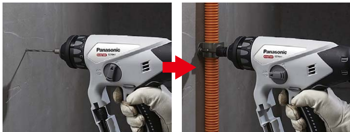
コンクリート穴あけ 《ハンマーモード》
