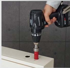
金工ホールソー穴あけ
