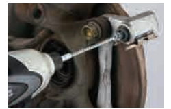
ブレーキキャリパーのスライドピンホルルの清掃に
