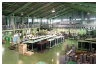
▲ バレル研磨を終えた製品の表面にめっきを施す自動ライン
