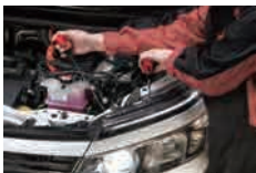
上下、左右2か所の光軸調整を同時に行う際、ADR10を2本使うと、より効率的な作業が可能。
