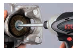
ブレーキキャリパーのリング溝清掃に
