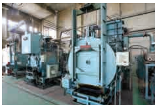
▲ ワーク洗浄までを自動化した真空焼入れ・焼戻しライン
