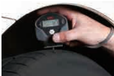
タイヤ溝の測定・点検記録の記入
