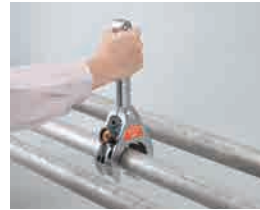
ラチェット機構とロータリーヘッドで狭い場所でも楽々作業。
