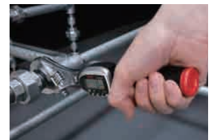
ソケットレンチなどを使用できない配管等の作業に適しています。
