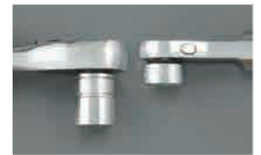
ヘッドは薄型のため従来のデジラチェでは作業が難しかった狭い箇所にも対応が可能
