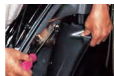
奥深い箇所でのクリップ取外しに最適です。
