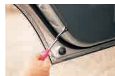
てこ作業で、内張りを傷をつけずに、クリップを簡単に取外し出来ます。
