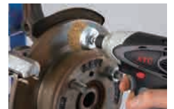
ブレーキローター表面の清掃・サビ除去に
