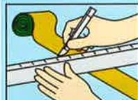
ノンスリップを裏面からカッターナイフ等で必要な寸法に裁断して下さい。角を丸くカットするとより一層はがれにくくなります。
